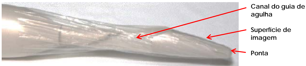
Figura 12: Transdutor EV29L com capa cheia de gel
