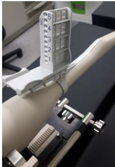
Figura 21: Transdutor EV29L com guia da agulha transperineal estéril EV29L introduzido (mostrado sem a capa)
