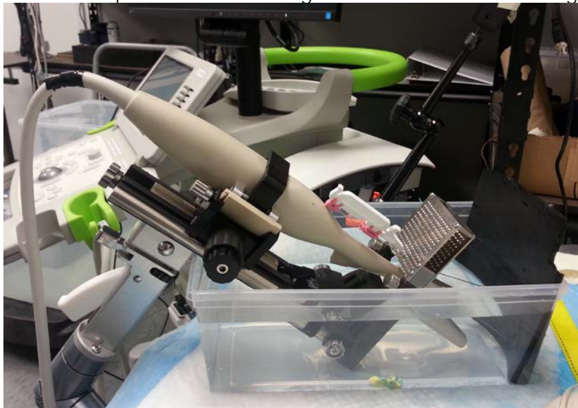
Figura 41: Transdutor e posicionador transperineal em banho de água
