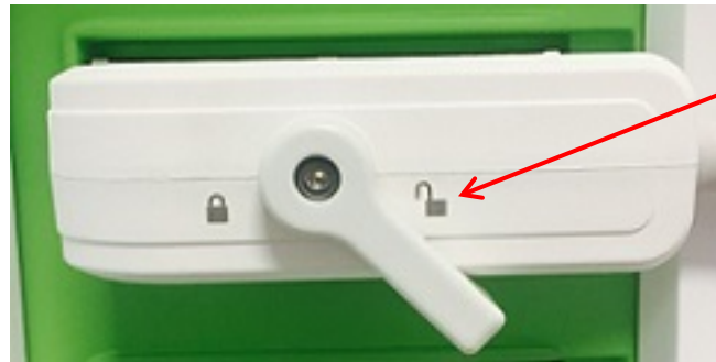
Figura 29: Trava do transdutor na posição desbloqueada
